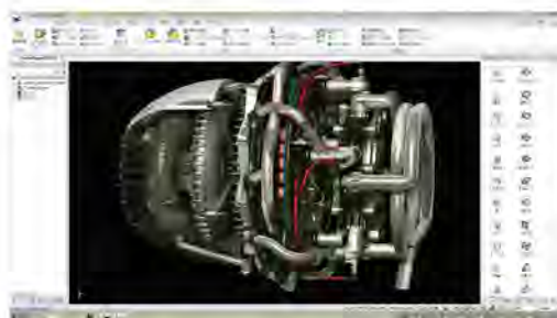
画面右側のカタログブラウザから必要な部品を選択して組み合わせることで、簡単に設計を行うことができる、日本語化されているのでわかりやすい
